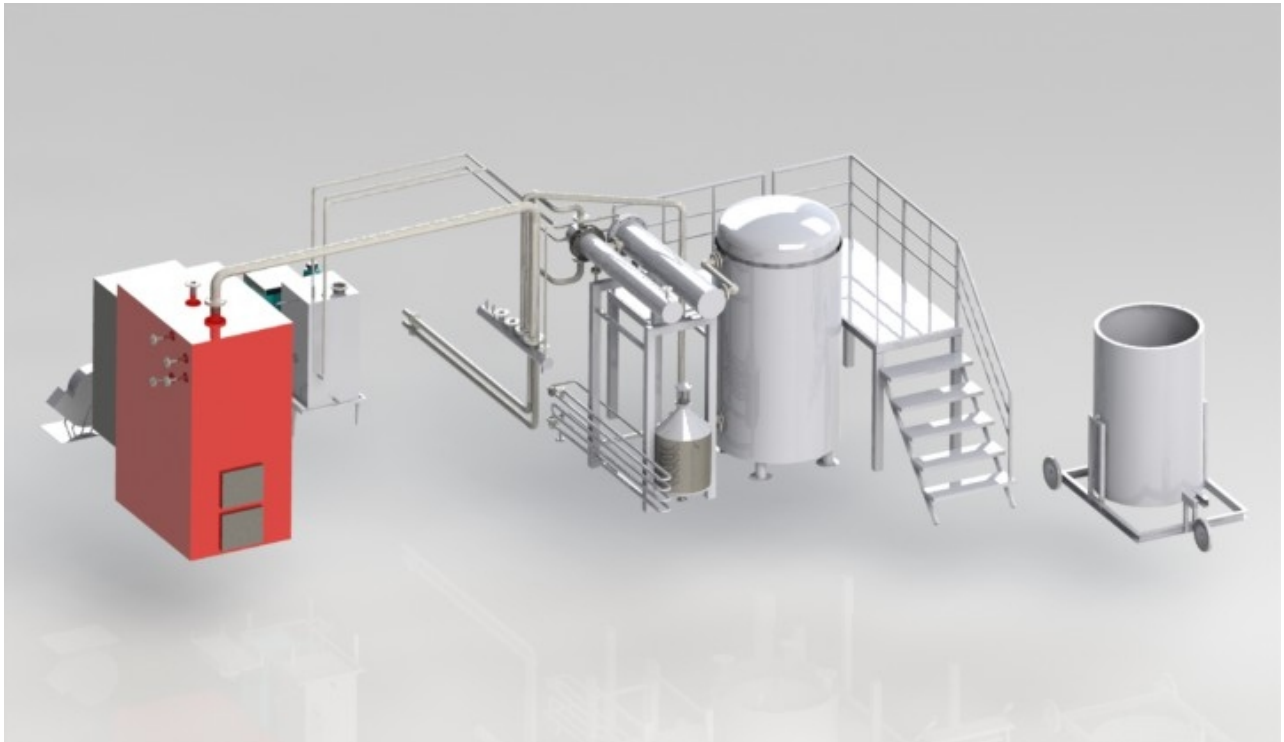
destilacija eteričnih ulja vodenom parom -destilaciono postrojenje DVK1000 sa kotlarnicom
